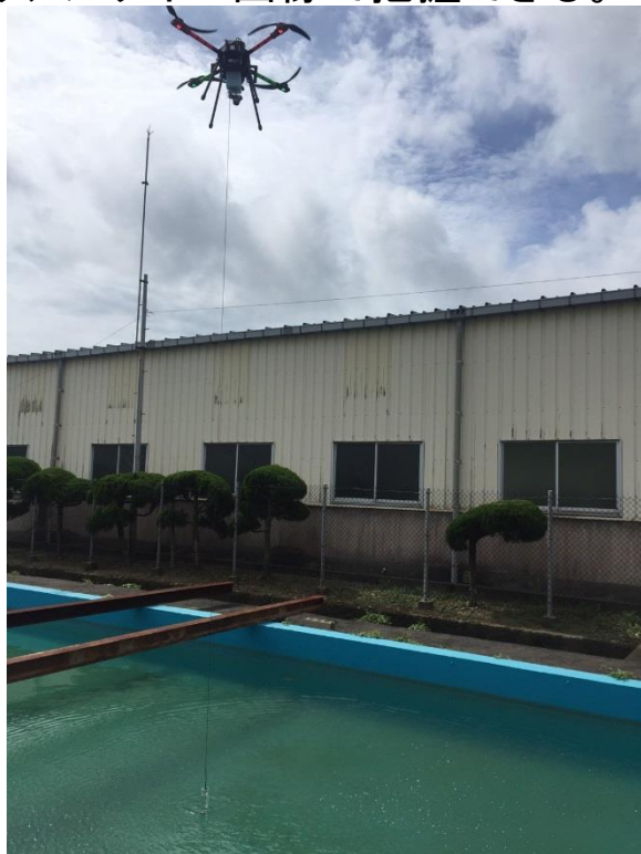
AKABOTの飛行採水機能試験
