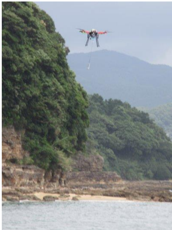
実海域での海水サンプリング試験
