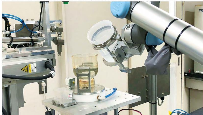
2019年12月に実用化した自動ろ過装置。これまでのような安全柵が必要なく、人のそばで協働作業ができる「協働ROBOT」を導入した。
