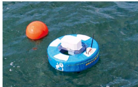
長崎大学と共同開発した水質調査用の水上ドローン
