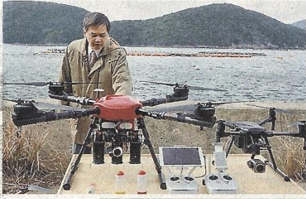
⑤自動航行し採水するドローン(左)の説明をする長崎大大学院工学研究科の山本郁夫教授。右側は空撮用のドローン④解析された水質などのデータは、養殖業者などに即座に通知できるという。
